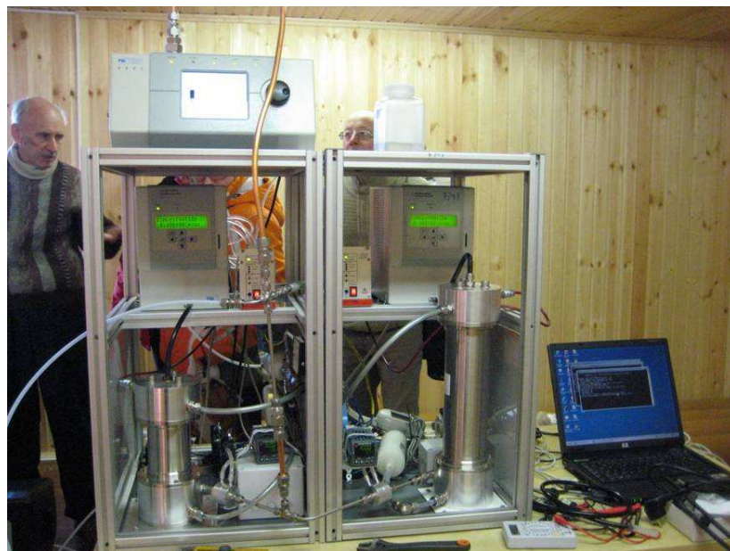
Рис. 2.7 Система сортировки аэрозолей по размерам, установленная ФМИ в ПЧВ
