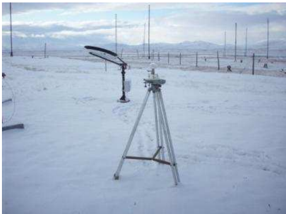
Рисунок 2.3. Российские датчики суммарной и рассеянной солнечной радиации, установленные в Гидрометеорологической обсерватории в Тикси в октябре 2009 года и пример информации о солнечной радиации, получаемой непосредственно в Центре данных Тикси в ААНИИ, С.Петербург, Россия.
