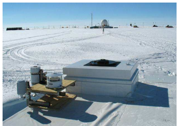
Рисунок 2.12 – Приборы для наблюдений ультрафиолетовой радиации: озонотер М-124 со сферой Лярше, установленный в Тикси в октябре 2009 г. (слева) и SUV-150В в Саммите, Гренландия (справа).
